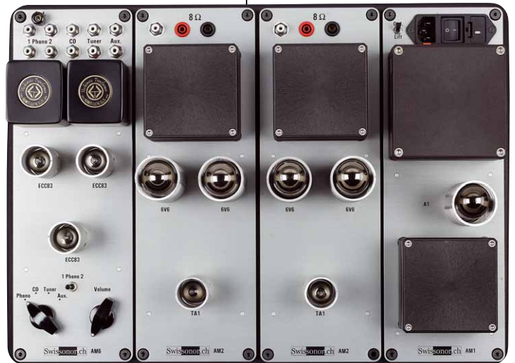
Vier Module im Gussrahmen: Bei der Bestückung des Verstärkers hat man die freie Wahl, wobei acht Watt aber schon die Leistungsobergrenze darstellen
