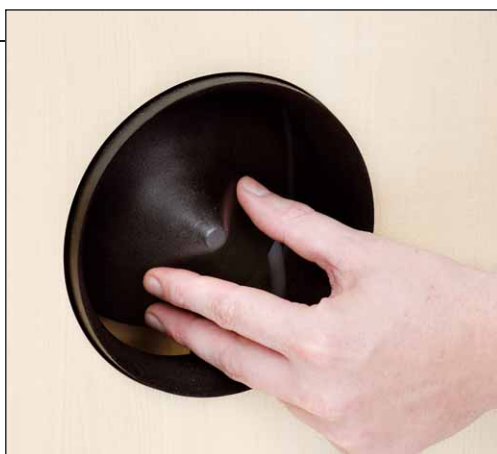
Der schraubbare Kegel beeinflusst die Größe der Bassreflexöffnung und damit den Basspegel unterhalb von 200 Hz
